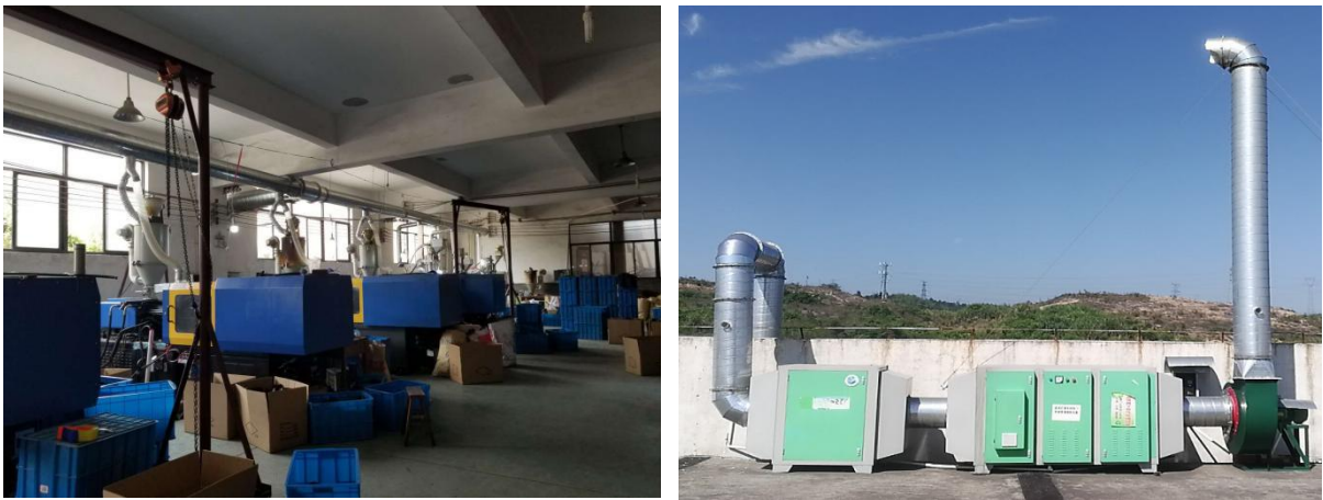
图 4-2 喷塑废气处理现场图
