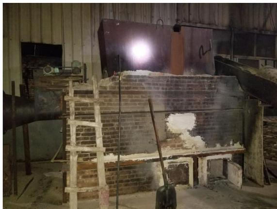
图 4-3 烘干气化炉现场图
