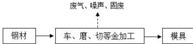
图 2-6 模具生产工艺流程图
