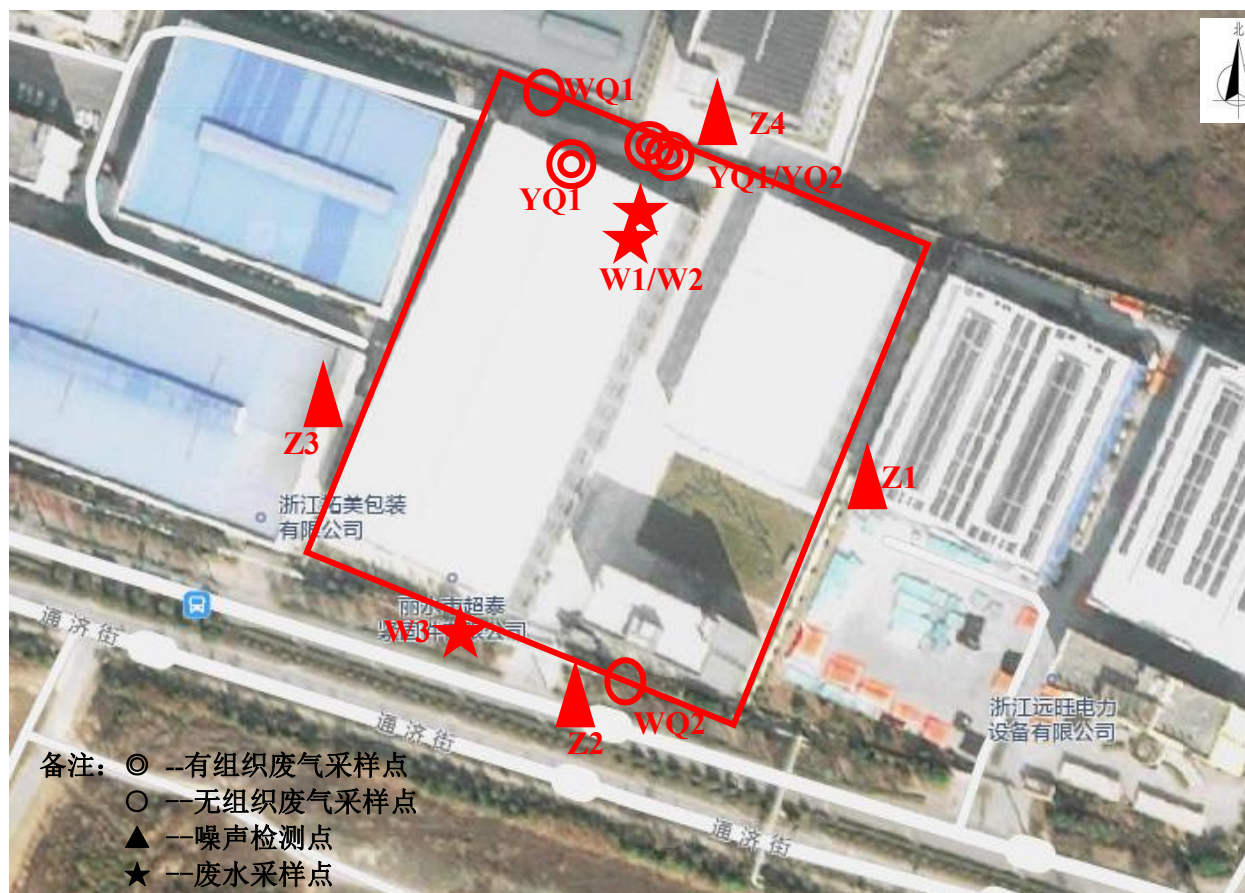
图 3-3 废水、废气、噪声监测点位示意图
