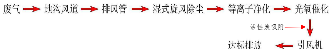
图 5-3 1#、2#喷漆房废气处理流程示意图
